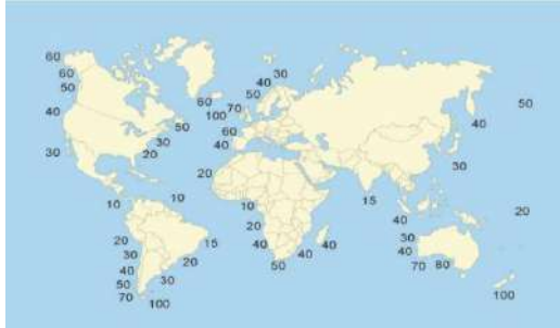
Fig.1 Recurso mundial de energía de las olas. Los números representan el flujo de energía promedio en (kwm) UPPSALA.
